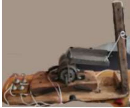
ნახ. 5. გრეხვით რხევებზე მომუშავე დიდი ამპლიტუდების ელექტროვიბრაციული მანქანა.
